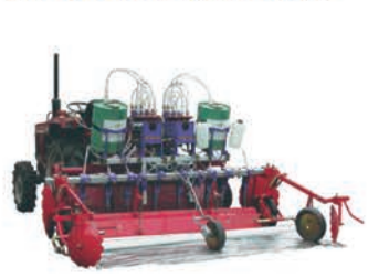
6 IDM-80 トラクター用同時マルチ土壤消毒機8条型
