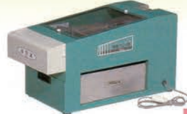
SN-B (A1-MSセットタイプ) そば適応型 2段網20メッシュ×60メッシュ
