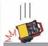
落下による故障
