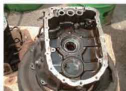
焼付いたパッキンのはく離に
