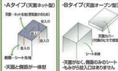
型式の表示 A:天面ネット型シート B:天面オープン型シート W:ワンタッチヒッチ仕様 D:電動開閉装置仕様
