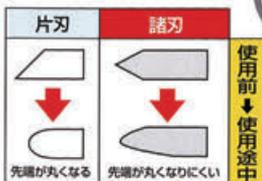
※下から摩耗していくので、諸刃の方が長切れします。
