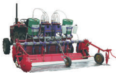
6 IDM-80 トラクター用同時マルチ土壤消毒機8条型
